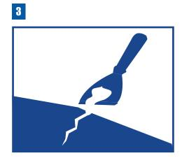
Resane con UNIMPER CEMENTO PLÁSTICO UNIBLOCK y refuerce con MALLA DE REFUERZO UNIBLOCK grietas profundas y puntos críticos como: chaflanes, domos, tuberías, fisuras, uniones de losas, juntas de construcción, etc. Las grietas deben estar libres de contaminantes.
